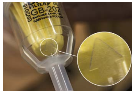
■ Стрелка должна быть направлена от печи к насосу
