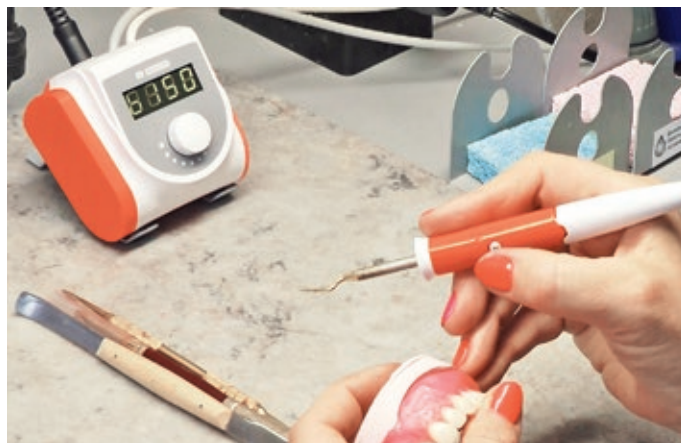
2 Когда необходимо пролить соединение воска с гипсом, включаем ускоренный нагрев
