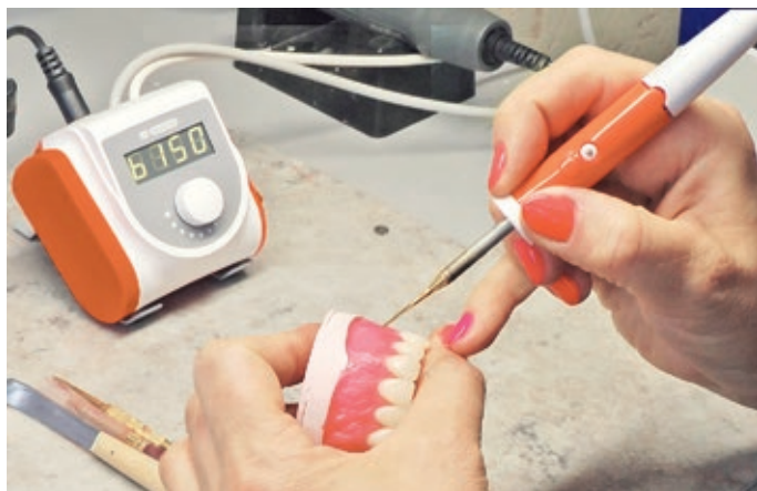
1 Моделирование производится при температуре, заданной на дисплее электрошпателя
