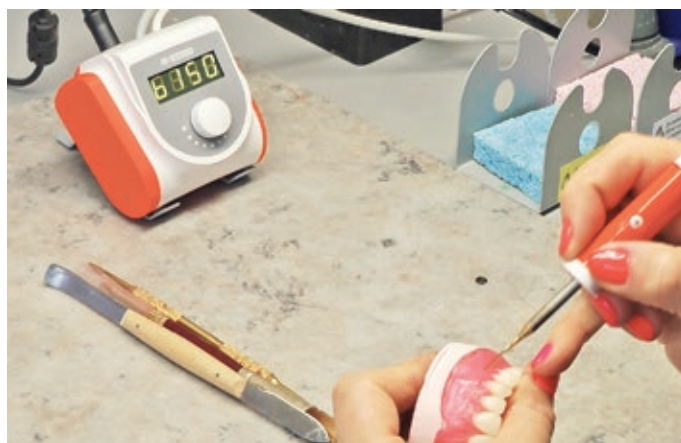
4 Закончив, отпускаем сенсор – температура вновь возвращается к заданной на дисплее. Можно продолжать моделировку.
