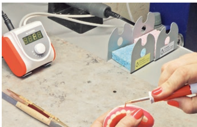
3 Насадка мгновенно разогревается до 250°С, что позволяет работать с более текучим воском
