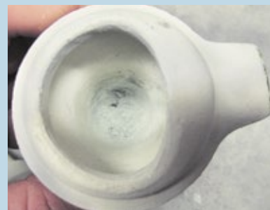
Предварительно обработанный составом БРОНЯ 100.0 ТИГЕЛЬ. На фотографии видно, что после литья следов почти не осталось.
