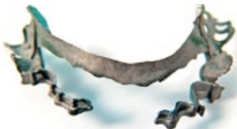
отливка расположена неверно относительно направления вращения центрифуги
