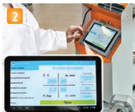
2 Кювету устанавливаем в ТЕРМОПРЕСС. Выбираем программу прессования для Evoplast. Запускаем программу на исполнение.
