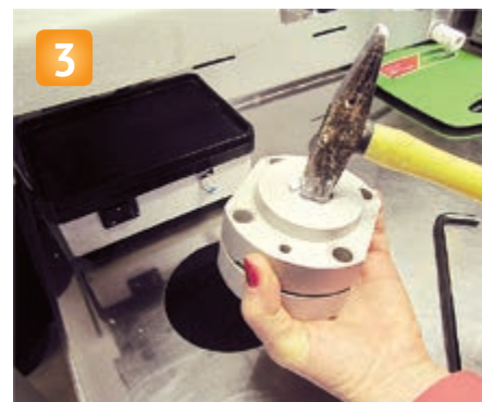
3 По окончании прессования снимаем кювету с ТЕРМОПРЕССа и оставляем до полного охлаждения при комнатной температуре. После охлаждения откручиваем болты и выбиваем гипс.
