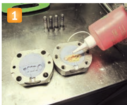
1 В зоне прессования на гипс наносим изоляцию, например, Appolon Sep. Излишки изоляции сдуваем воздухом.
